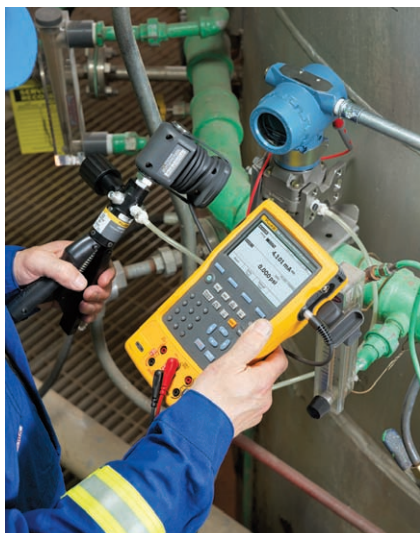
Ukážka kalibrácie HART prevodníka tlaku pomocou kalibrátora Fluke 754
